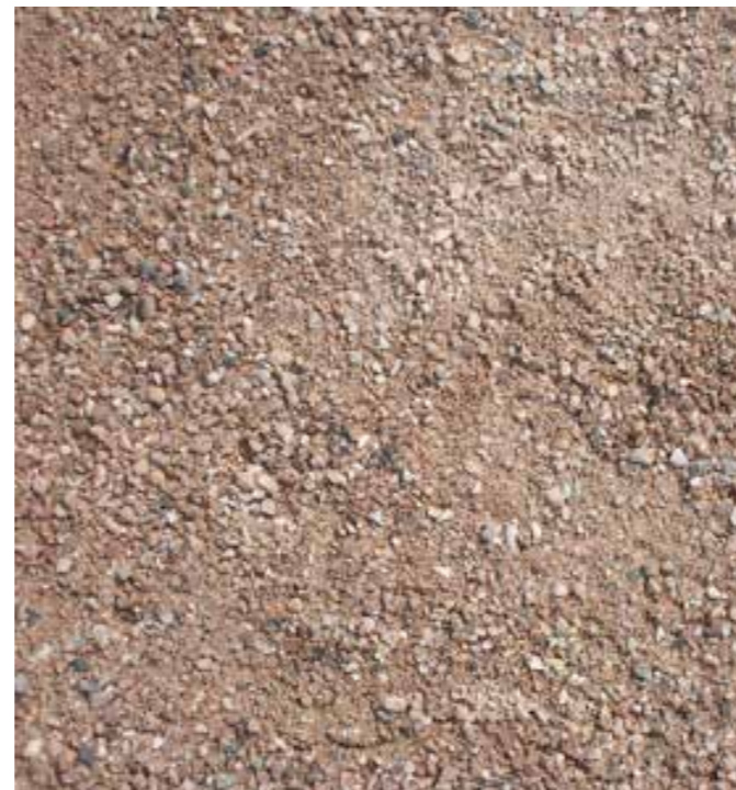
Wassergebundene Deckschicht zum Beispiel: Dolomitsand 0/5, Materialauswahl nach Bemusterung
