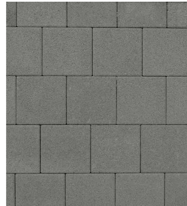
zum Beispiel: Betonsteinpflaster, Kleinformat, Anthrazit Format 20x20x10 cm Verortung: Gehwege, Kiss&Ride
