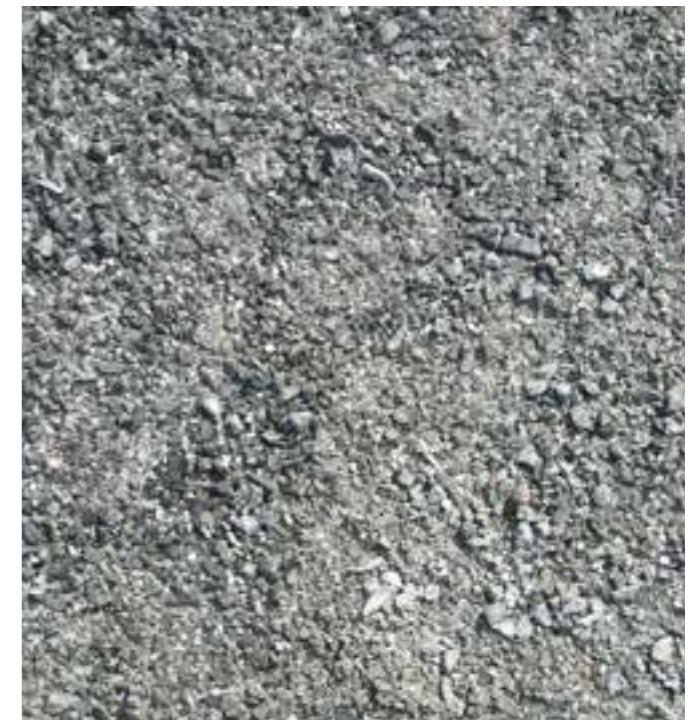
Wassergebundene Deckschicht zum Beispiel: Basaltsplittsand 0/5, Farbe anthrazit
