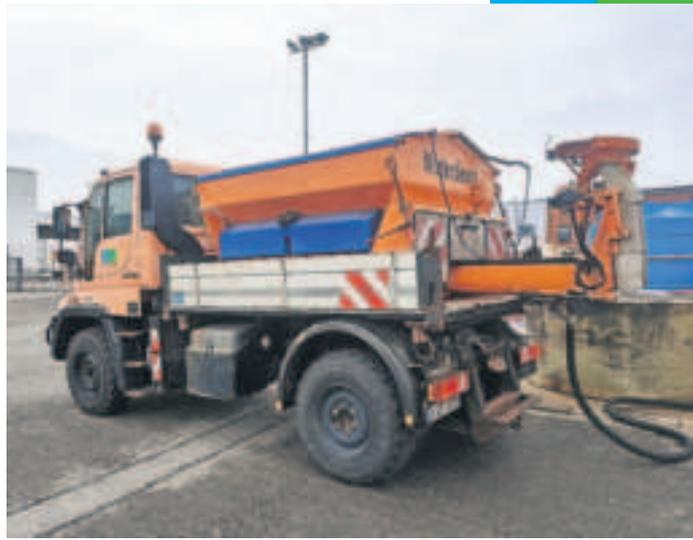
Treues Arbeitstier: der Mercedes Unimog U 300 beim Befüllen des Feuchtsalz-Tanks.
