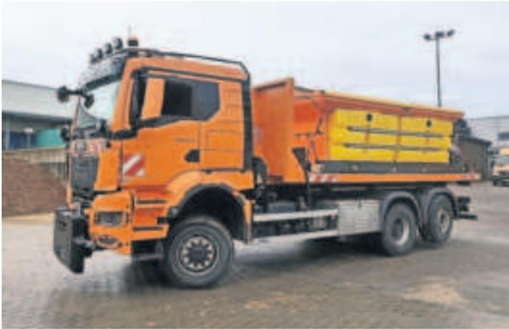
Der jüngste Neuzugang: Streu- und Räumfahrzeug MAN TGS 28.510, Nutzlast etwa 13 Tonnen.
