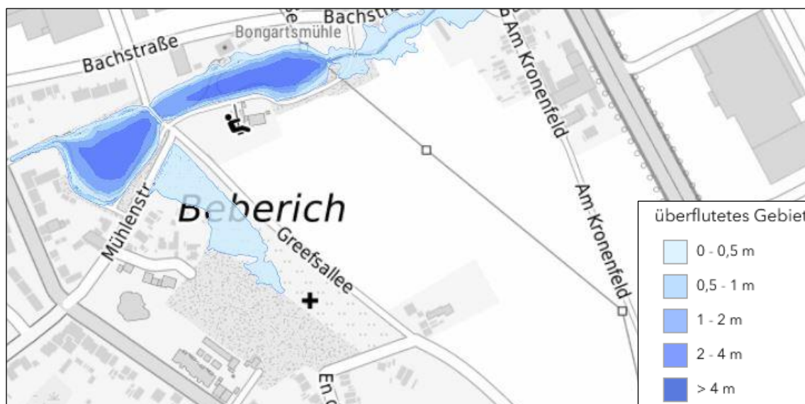
Abb. 5: Hochwassergefahrenkarte - Hochwasserszenario: niedrige Wahrscheinlichkeit (HQ extrem )
