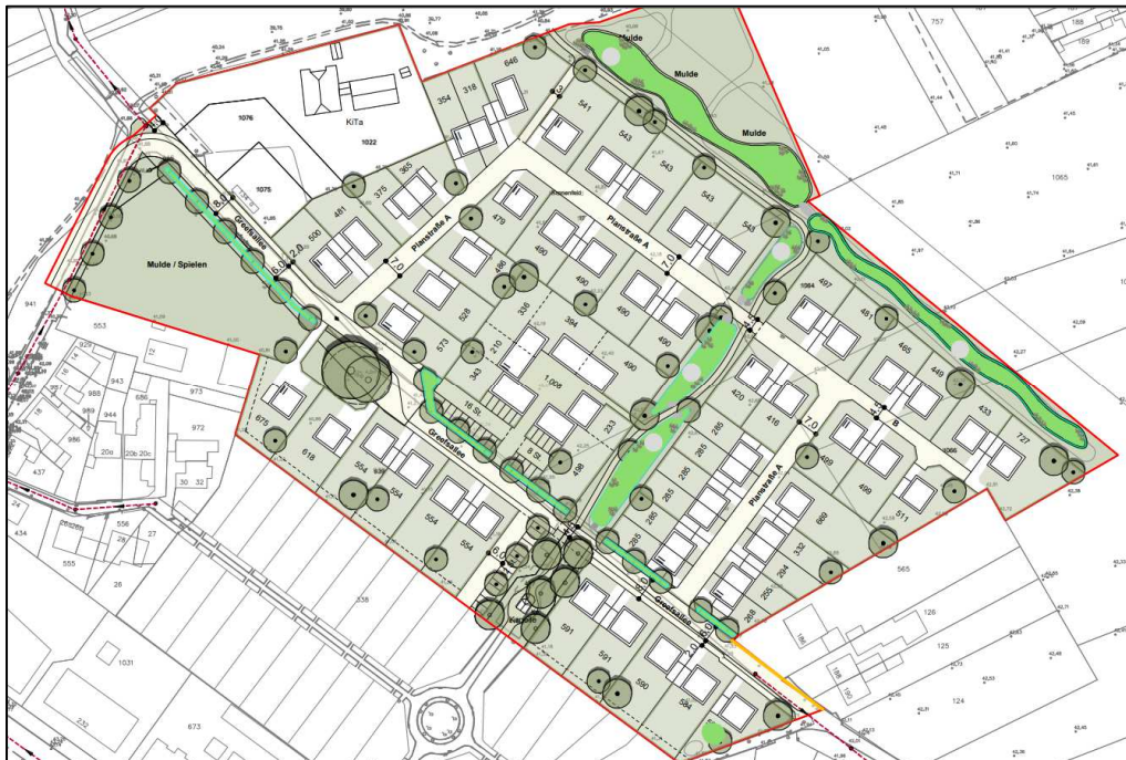
Abb 1: Übersicht städtebauliches Konzept mit Versickerungsmulden
